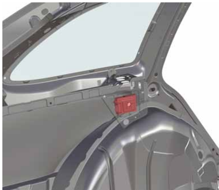
Positionnement de l'unité de commande de la télé- commande sur le modèle Škoda Superb Combi SP79_14
