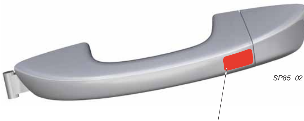
Surface des capteurs capacitifs pour verrouiller le véhicule
